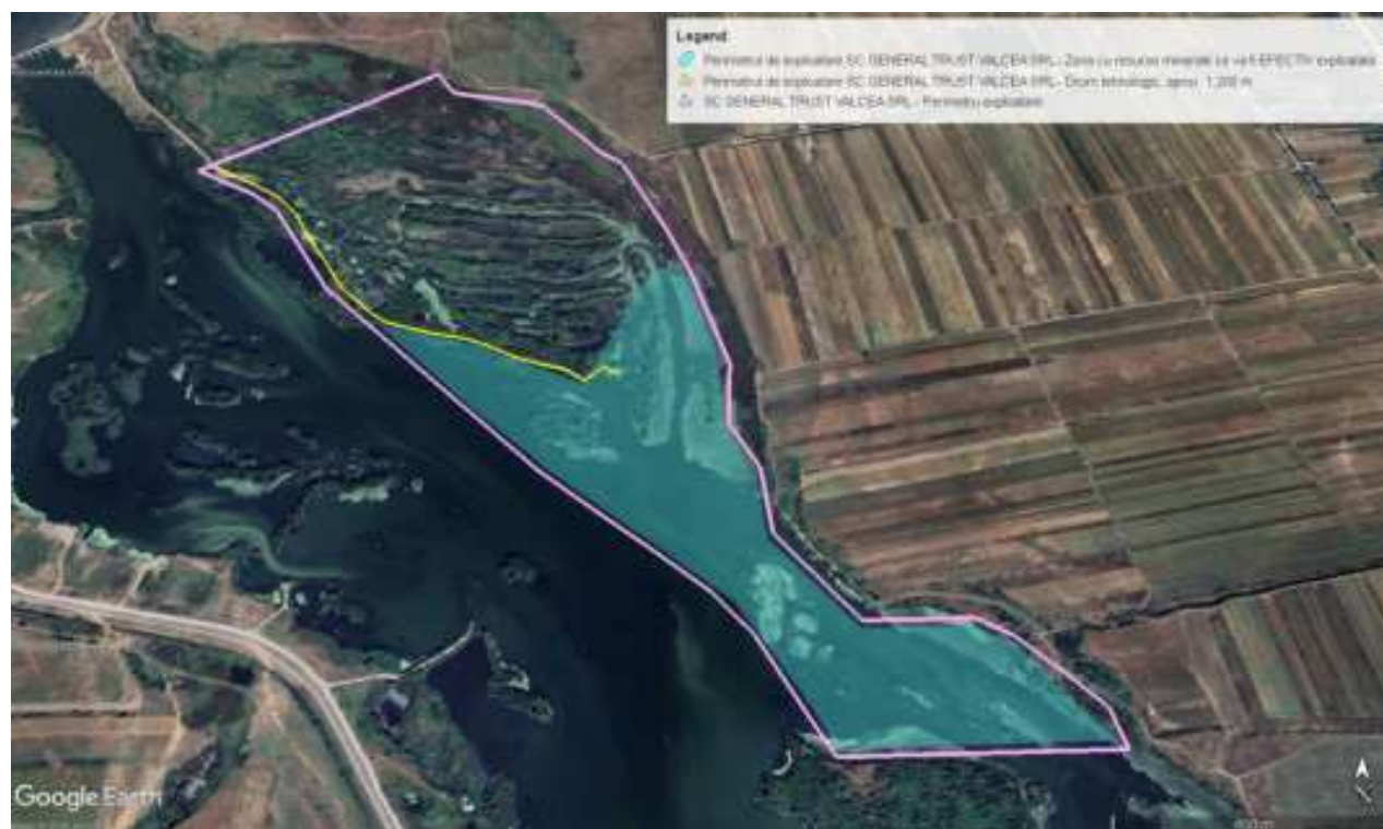
Figura nr. 7. Zona cu resurse minerale (nisip și pietriș) ce va fi EFECTIV exploatată, raportată la suprafața totală a perimetrului de exploatare. Drum tehnologic în interiorul perimetrului de exploatare
